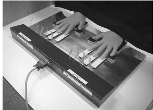
Afbeelding 1. Opstelling die gebruikt is om haptische zoektijden te meten in een statische haptische zoektaak. Onder de vingers van de proefpersoon bevinden zich de stimuli, welke zijn gemaakt van zwelpapier. De sensoren die zich hier weer onder bevinden kunnen de tijd dat de vingers zich op de stimuli bevinden meten.
